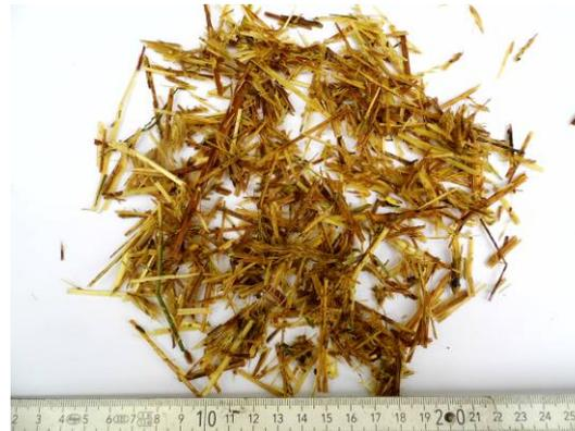
**Stroh nach Aufstromhydrolyse**
