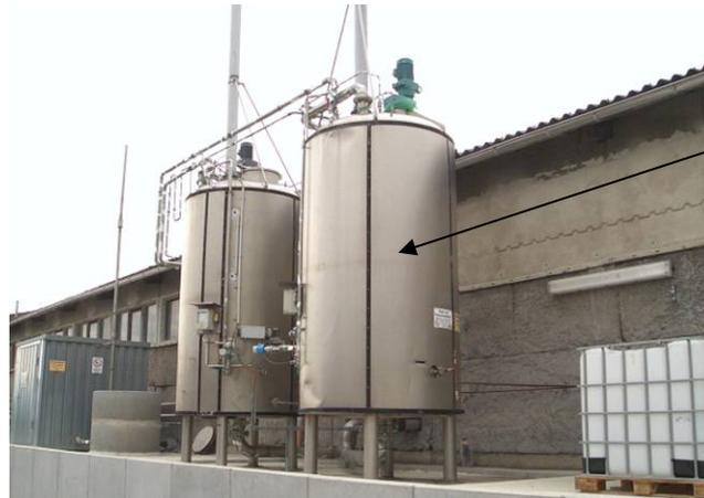
Kleintechnische Anlage 2x5 m<sup>3</sup> in Containerbauweise mit Aufschlusstechnik für kontinuierlichen Betrieb
