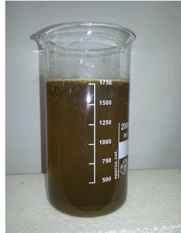
Stroh, mit Bioextrusion bis ins Zellgefüge aufgeschlossen
